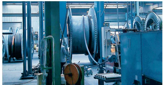
Bild 3: Biegeprüfung vor dem Start zur elektrischen Typprüfung.
