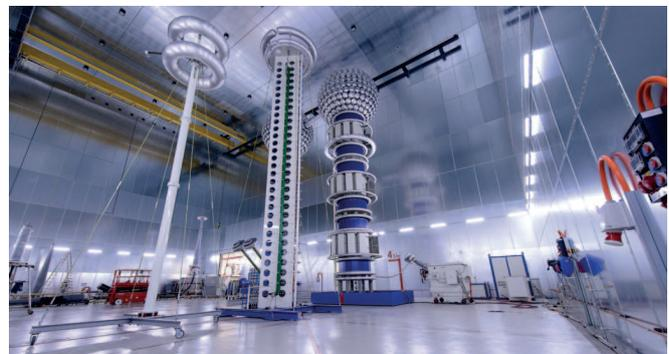
Bild 4: Stossspannungsgenerator zur Prüfung des Stosspannungsverhaltens der Kabel.
