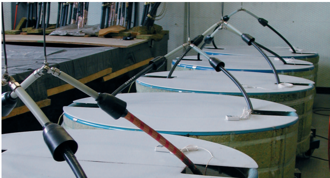
Figure 2: Test de longue durée d'après HD 605 S2 et HD 620 S2.
