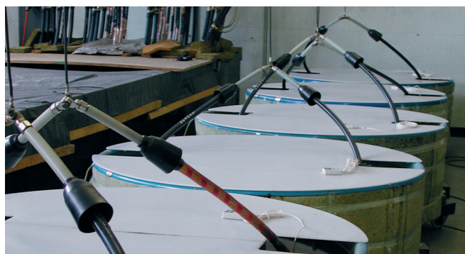
Bild 2: Langzeitprüfung nach HD 605 S2 und HD 620 S2
