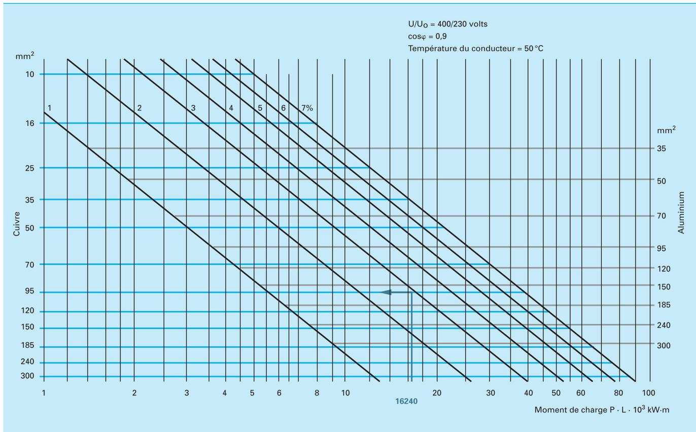
Figure 7: Section du câble en tenant compte de la chute de tension.
