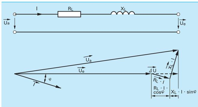
Figure 6: Représentation schématique de la chute de tension.
