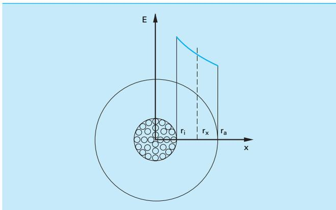
Figure 1: Tracé radial de l'intensité du champ.
