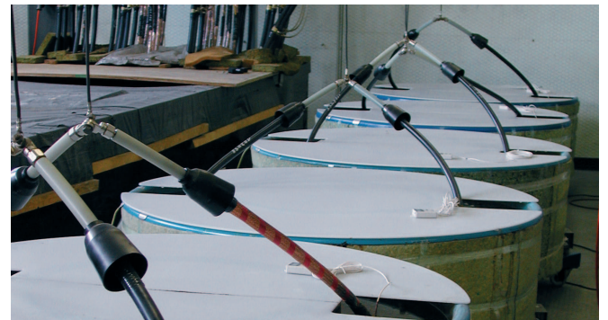
Bild 2: Langzeitprüfung nach HD 605 S2 und HD 620 S2
