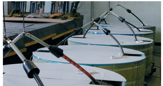
Bild 2: Langzeitprüfung nach HD 605 S2 und HD 620 S2
