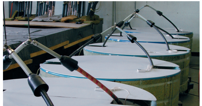
Figure 2: Test de longue durée d'après HD 605 S2 et HD 620 S2.
